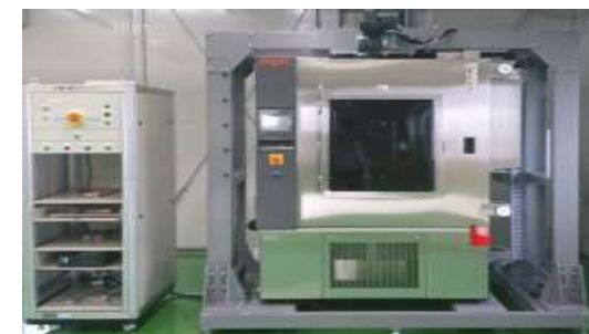
釘刺し・圧壊試験装置 内部をWebカメラにて動画記録が可能
